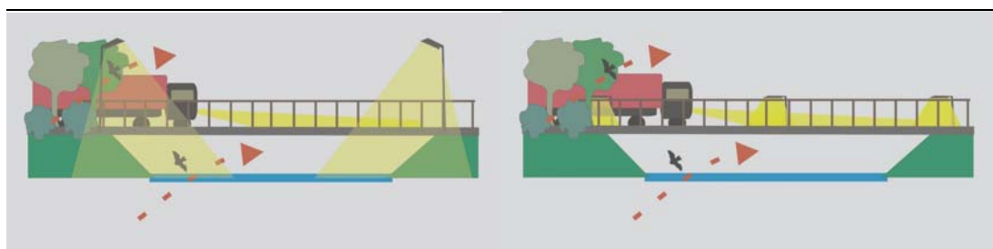
Figuur 3.11 Voorkom verstrooiing van licht vanaf de bovenzijde van het brugdek door de verlichting lager aan te brengen (Zoogdiervereniging, 2012)
