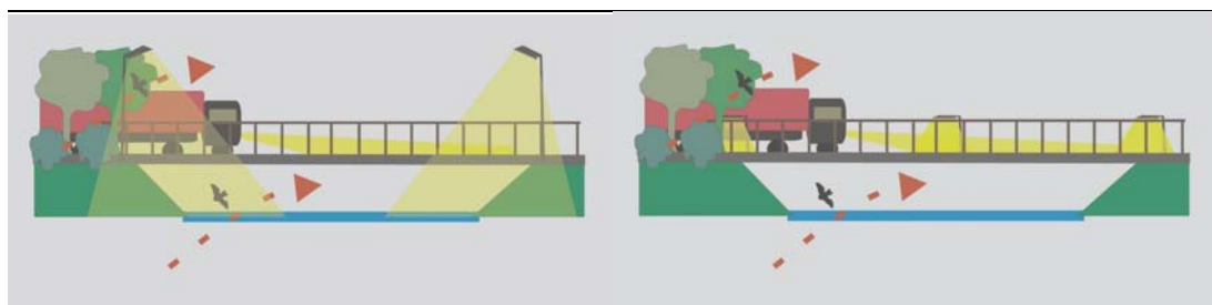
Figuur 3.12 Vermindering van verstrooiing van licht door lager aanbrengen van verlichting
