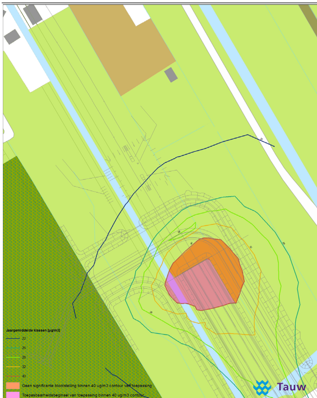
Figuur 7 Resultaten met toepasbaarheidsbeginsel (paars gemarkeerd) en geen significante blootstelling (oranje gemarkeerd) Jaargemiddelde concentraties \text{NO}_2 oostelijke tunnelmond
